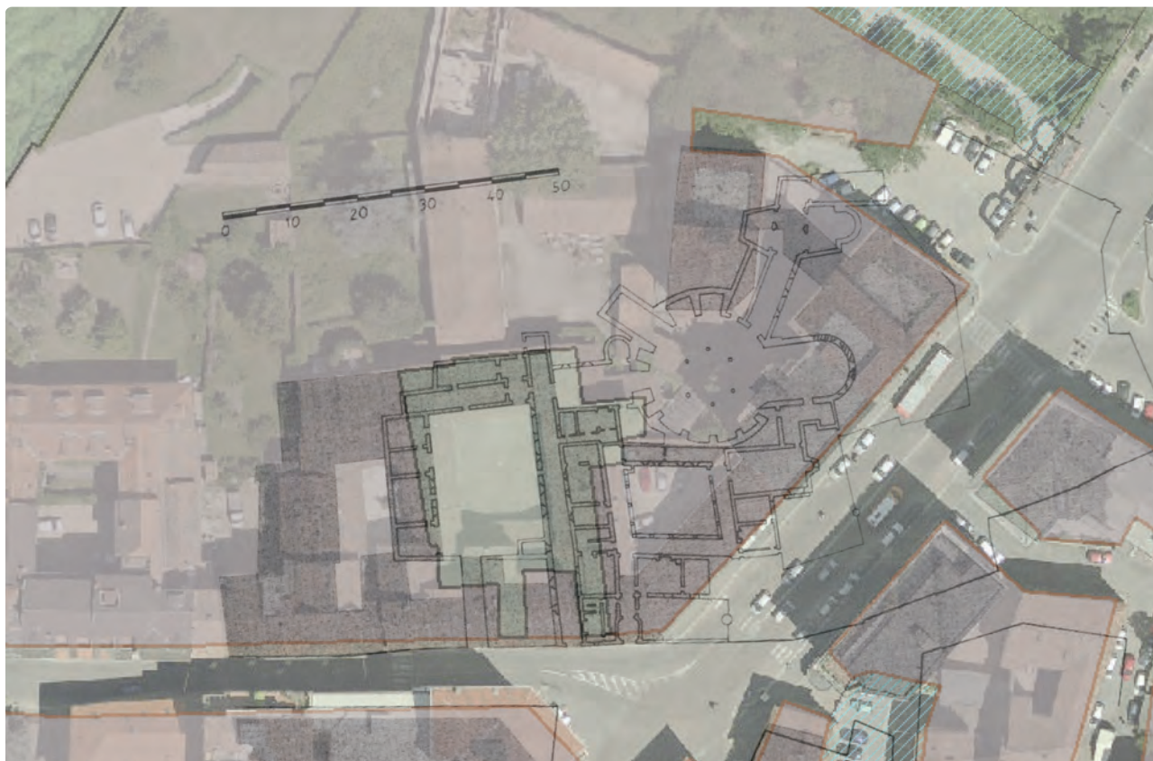
Fig. 5. Sovrapposizione del rilievo planimetrico di C. G. Dalloro (cfr. Fig. 4, schema di D. Tolomelli) di Santa Maria alle Pertiche di Pavia e della veduta zenitale della corrispondente area urbana odierna (elab. dig. di S. Lomartire).
