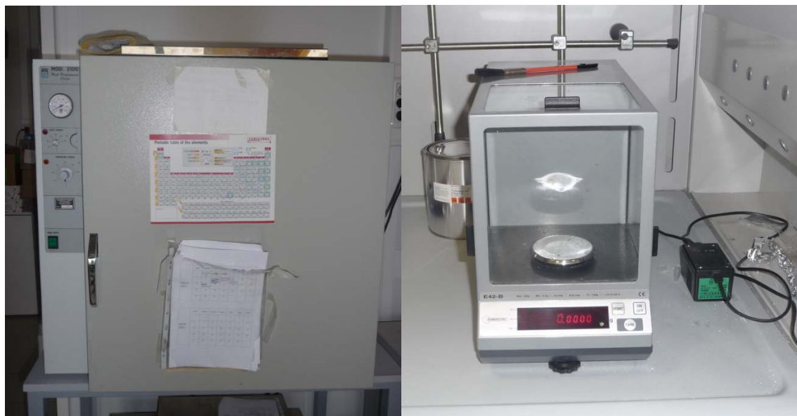
Figura 3.14: Stufa e bilancia utilizzate per la quantificazione del CPOM (foto T. Bo).
