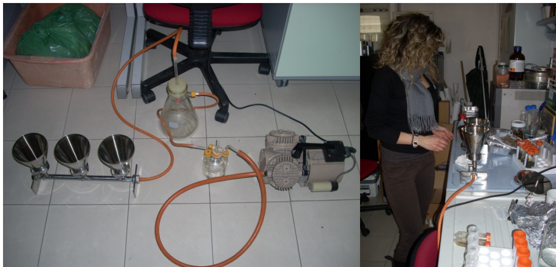
Figura 3.5: Sistema di filtraggio e fasi del lavoro (foto T. Bo).
