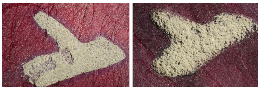
Abb. 6 Mikroskop-Aufnahmen von rekonstruierter Silbertusche auf Purpurpergament, hergestellt aus von mit der Hand geriebenem Schlagmetall (links) und von im Mörser geriebenen Silberspänen (rechts).
